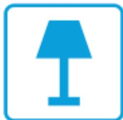
Diese Leuchte enthält eingebaute LED-Lampen.
